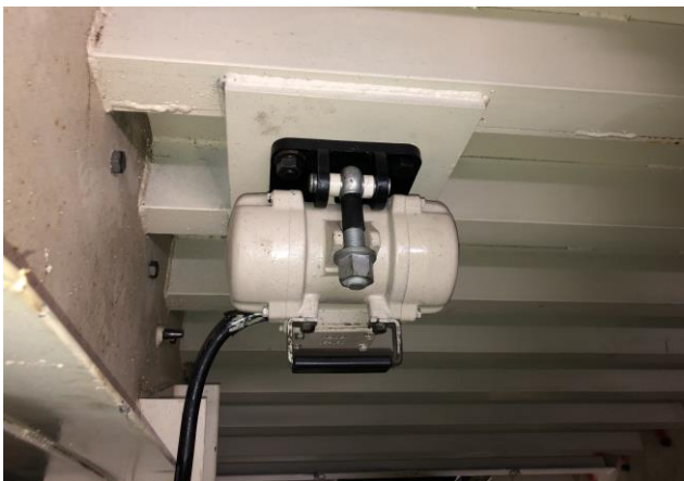
バイブレーター
